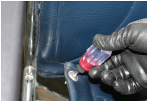
③ 시트 양쪽 천 안쪽 고정대, 천, 프레임 구멍을 일치시킨 후 십자나사를 이용하여 나사를 결합한다. ※ 이때 나사는 오른쪽(시계방향)으로 돌려서 조립한다.
