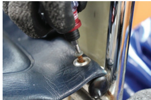
③ 시트 양쪽 천 안쪽 고정대, 천, 프레임 구멍을 일치시킨 후 십자나사를 이용하여 나사를 결합한다. ※ 이때 나사는 오른쪽(시계방향)으로 돌려서 조립한다.
